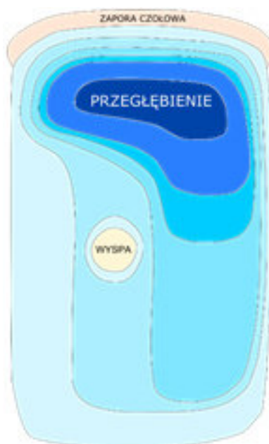
Tarasowy, schodkowy przekrój dna na starym stawie wprowadzony celem adaptacji obiektu do zmian klimatu.
